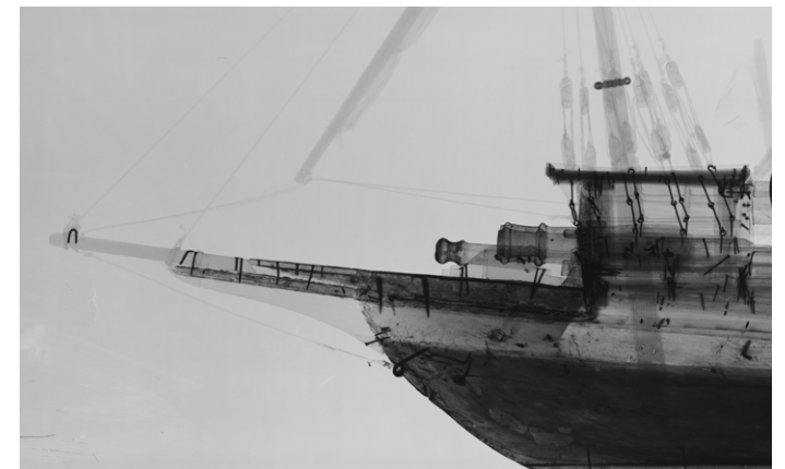
▼ A la imatge invertida de la radiografia de proa, es veuen els elements de ferro i es diferencien les fustes sense policromia. (CRBMC).
