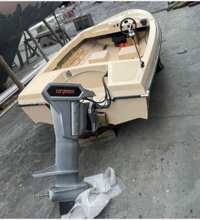
▲ La conversió a elèctric permet revaloritzar vaixells antics, com és el cas d'aquesta Llanxa Nuova Concord. Foto: Adrià Fradera.
