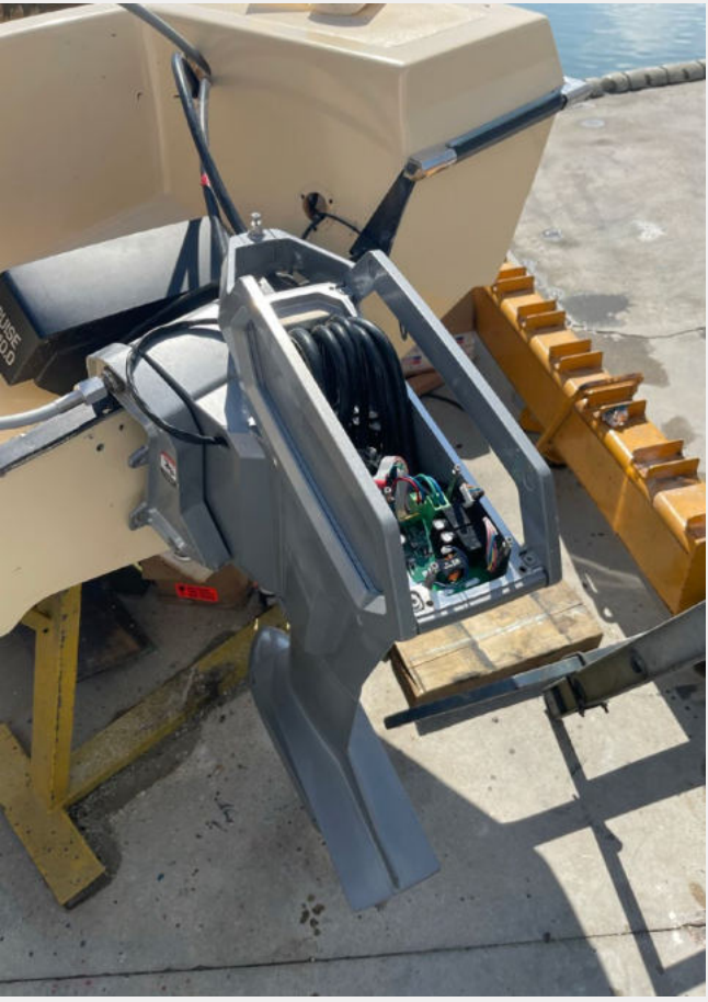
▲ La conversió a elèctric permet revaloritzar vaixells antics, com és el cas d'aquesta Llanxa Nuova Concord. Foto: Adrià Fradera.
